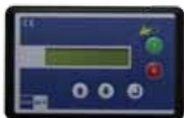
Электронный контроллер с LCD дисплеем LOGIK (Италия). Обеспечивает управление рабочими процессами компрессора, контроль и отображение рабочих параметров на двухстрочном русифицированном дисплее, таймер сервисных интервалов по каждому элементу, вывод аварийных сигналов, передачу данных на удаленный компьютер посредством интерфейса RS 232;
