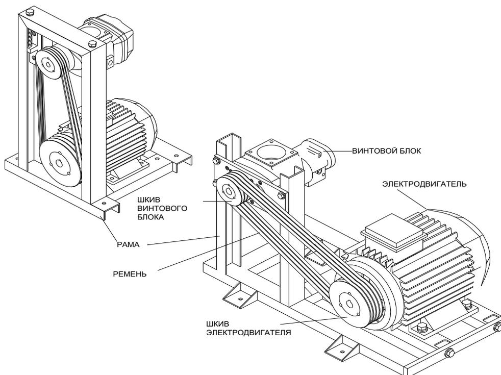
Для передачи вращающего момента к винтовому блоку используется механический привод. Система включает в себя раму, электродвигатель, винтовой блок, шкивы и ремни. Приводной электродвигатель и винтовой блок смонтированы на единой раме. Передача мощности осуществляется клиновыми ремнями.
