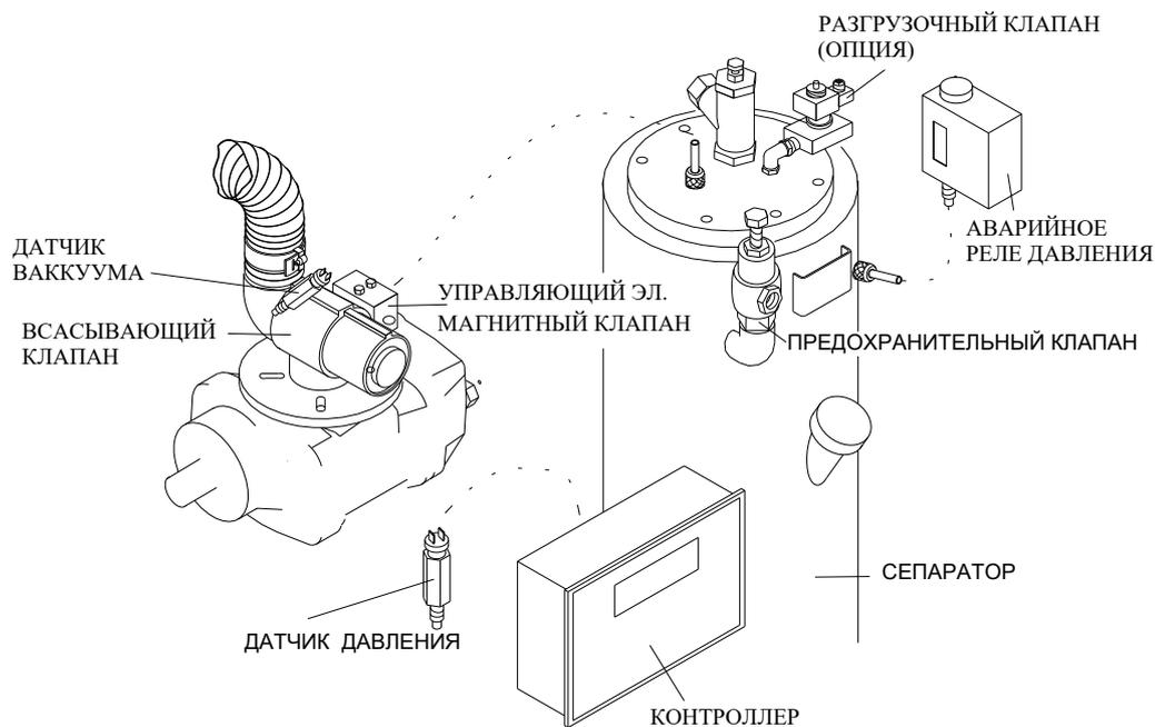
Система управления всасыванием состоит из всасывающего клапана, электромагнитных клапанов и реле давления. В системах с электронным контроллером и частотным регулированием, для контроля давления используются электронные датчики.
