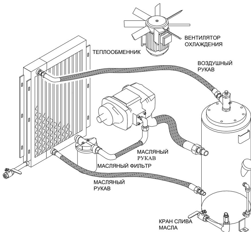
Как показано на рисунке система охлаждения состоит из теплообменника, вентилятора охлаждения, масляного фильтра, корпуса сепаратора и соединительных рукавов.
