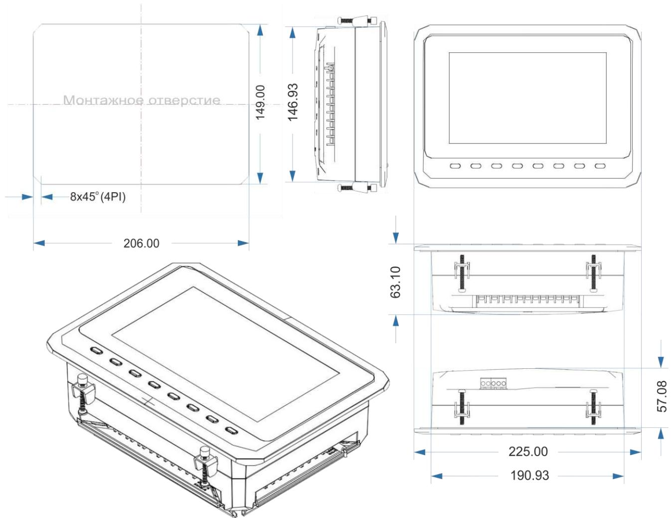
**Примечание:** Поскольку размер задней стенки 190.93 мм, размер отверстия должен быть как минимум 206 мм. После подключения кабеля до задней стенки должно остаться около 10-15 мм свободного пространства. При этом при установке контроллера кабель можно подключать не сразу.
