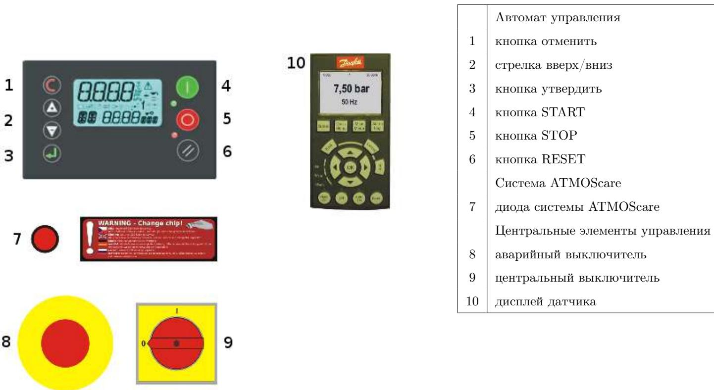
Все функции компрессора управляемы контроллером находящимся на передней панели. Кнопками стрелок (вверх и вниз) можно переключать указанные данные на дисплее (температура, рабочие часы и под.). Кнопка RESET используется к аннулировке тревожных входов (если тревога не находится в постоянной активности) и к тому, чтобы вернуться к исходному экрану.
